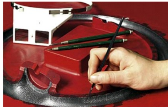
在蚀刻之前将菲林底片粘贴在相应的模具表面
