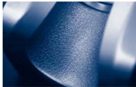
塑料注塑模具型腔表面的皮革组织皮纹效果
